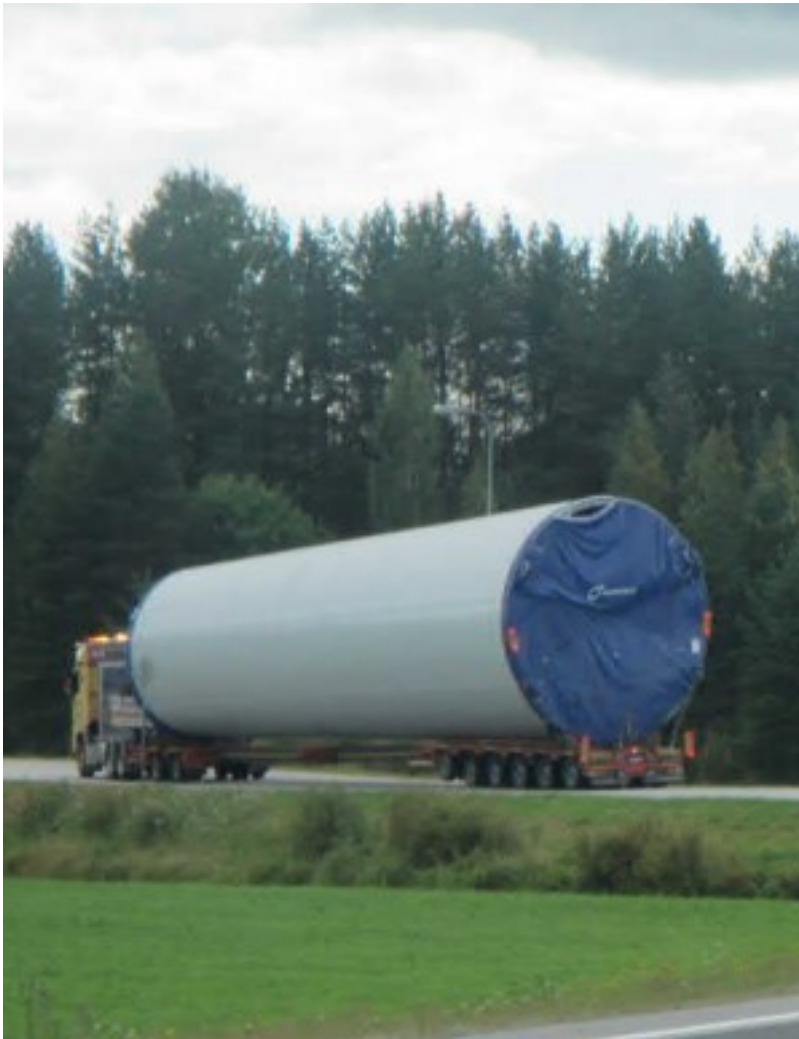
KUVA 6. Tuulivoimalan tornielementti kuljetuksessa (Pohjois-Pohjanmaan ELY-keskus 2023)
