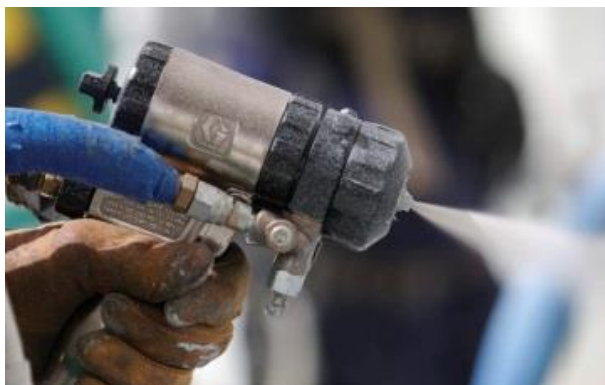
Kuva 4. Ruiskutuspistooli Fusion Air Purge (Graco Fusion Air purge 2014a.)
