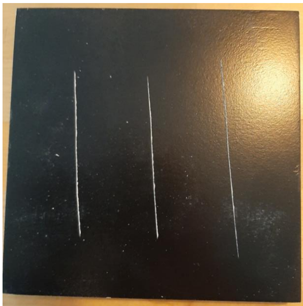
Kuva 13. Kuivakalvopaksuuden määrittäminen mustaksi maalatulle levylle.
