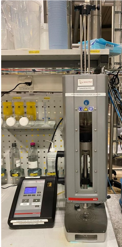
Kuva 4. Opinnäytetyön kokeellisen osion mittauksissa käytetty Anton Paarin CarboQC-hiilidioksidimittauslaite.
