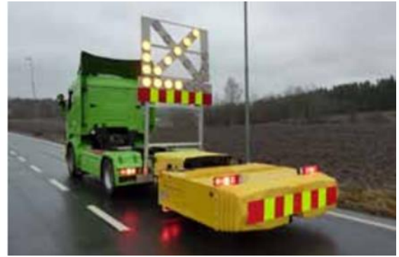
KUVA 5. Norjassa käytössä olevia törmäysvaimentimia vasemmalla TTMA ja oikealla TMA. (Kuva: Statens vegvesen)
