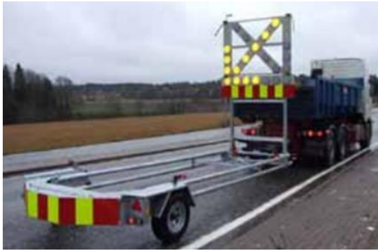
KUVA 5. Norjassa käytössä olevia törmäysvaimentimia vasemmalla TTMA ja oikealla TMA. (Kuva: Statens vegvesen)
