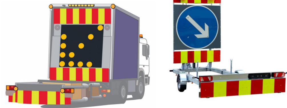
KUVA 2. Vasemmalla Suoja-ajoneuvo törmäysvaimentimella TMA (Kuva: Väylävirasto) ja oikealla törmäysvaimennin traileri TTMA. (Kuva: Elpac Oy)
