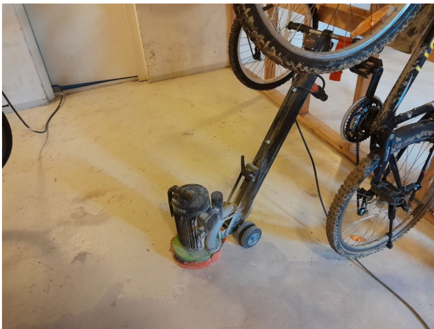
Kuva 4. Lattioiden hiontaan soveltuva, kohdepoistolla varustettu timanttihiomakone.
