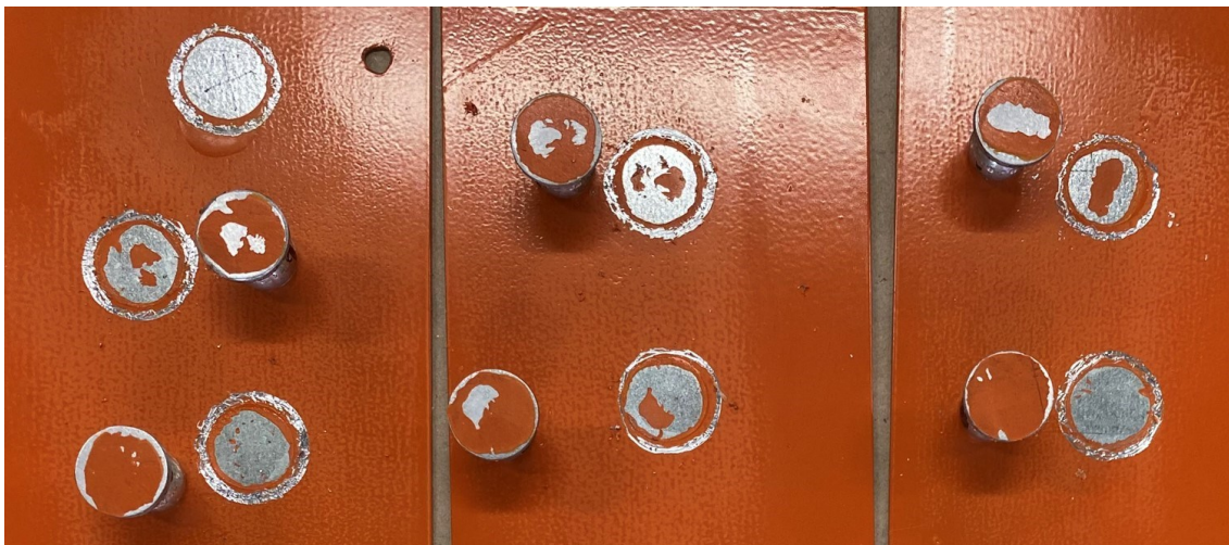
Kuva 8. Maalatuille koelevyille tehtyjen irtivetokokeiden seurauksena muodostuneiden erilaisten murtopintojen pinta-alojen suhteelliset osuudet voidaan arvioida silmämääräisesti. Irralliset irtivetokappaleet on asetettu levyjen päälle niin, että murtuneet kiinnityspinnat osoittavat kohti kameraa.
