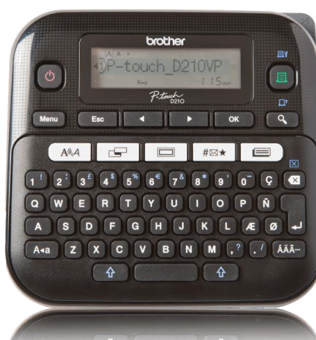
Kuva 11. Brother-tarratulostin. Tulostimessa on oma näppäimistö, mutta sitä voidaan käyttää myös täysin tietokoneen kautta.
