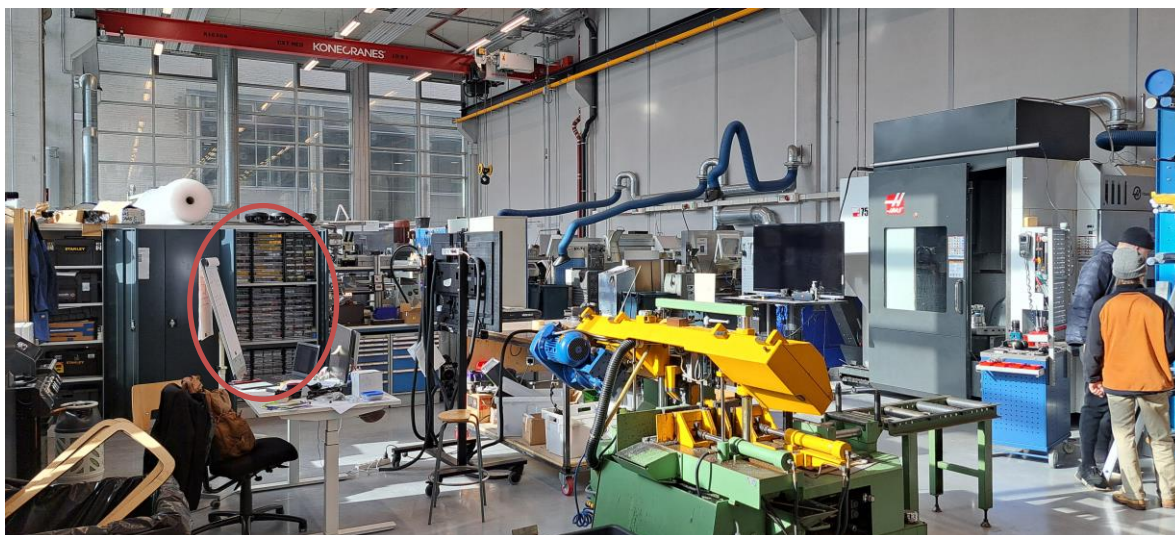
Kuva 1. Koneistuslaboratorio. Kuvassa näkyy muun muassa edessä saha, Haasin koneistuskeskus ja työkalukaappi punaisella ympyröitynä
