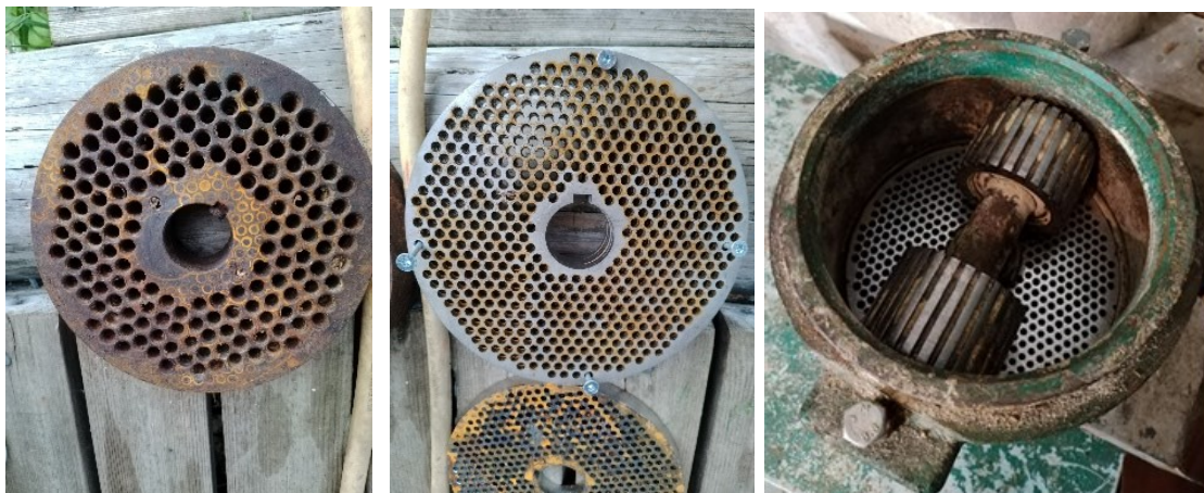
KUVA 9. Vasemmalla vanha 8 mm:n matriisi, keskellä uusi 5 mm:n matriisi ja oikealla kolleripyörät (Jäkälä 2023c)
