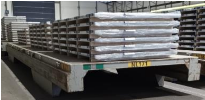
Kuva 3. Nauhalevyjen kuljetukseen suunniteltu NL-alusta [3]
