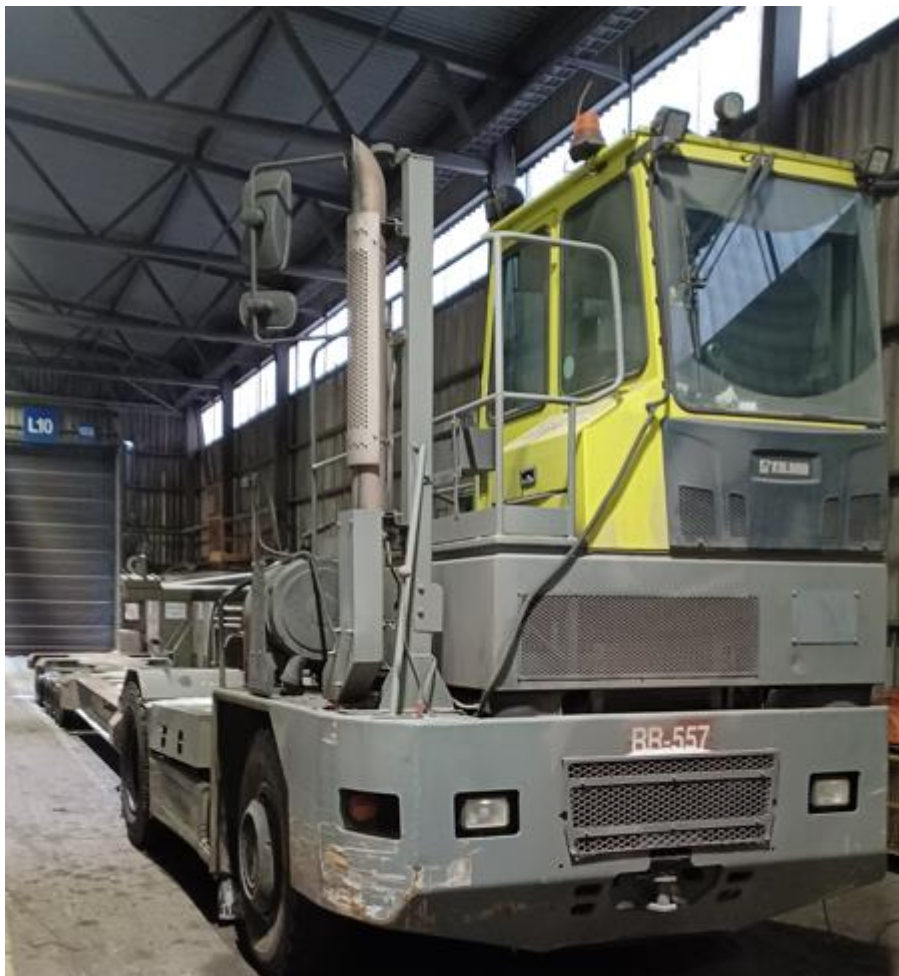
Kuva 2. Tuotealustojen kuljetukseen käytettävä vetomestari [3]
