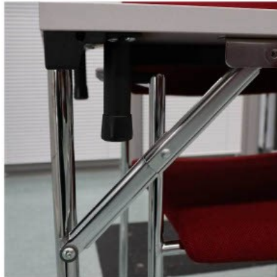
Kuva 31. Pöydän alla olevia rautoja, jotka pienentävät vapaata polvitilaa pöydän alla. Raudat mahdollistavat pöytien jalkojen taittamisen varastoinnin ajaksi.
