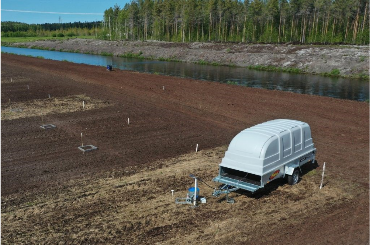
KUVA 2. Automaattikammio Ruukin koeaseman tutkimusalustalla (kuva: likka Jurva).
