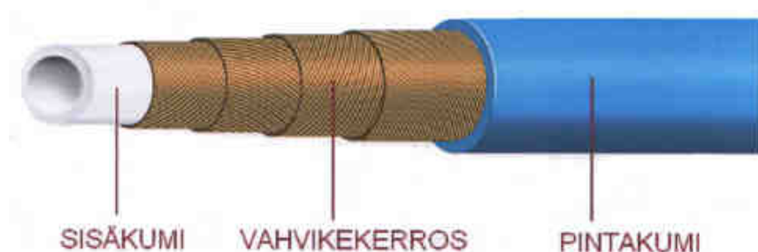
Kuva 4. Polttoaineletkun rakenne /8/
