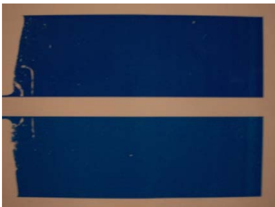
Kuvio 6: Kahden suorakaiteen muotoisen painolaatan antama painojälki painettuna PE-2-näytteeseen
