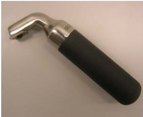
Kuvio 11: Elcometer hilaristikkoviiltolaite
