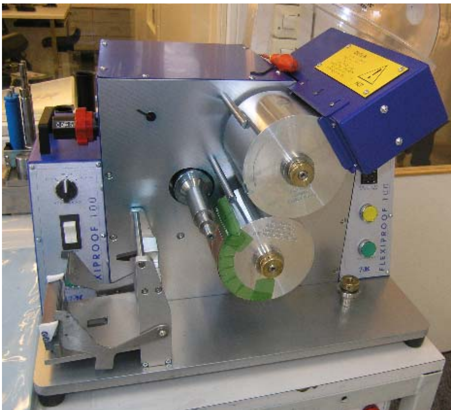
Kuvio 3: RK Flexiproof 100 -testipainolaite
