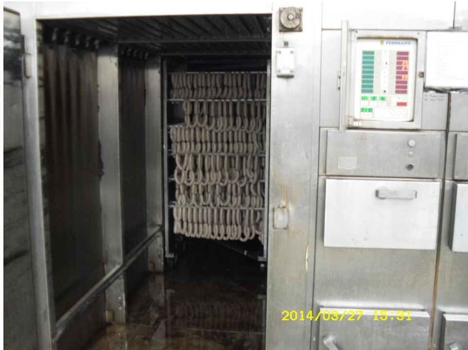
Kuva 4. Fessmann 2 -uuni sisältä sekä ohjauspaneeli. (Kuva: Martti Raski)
