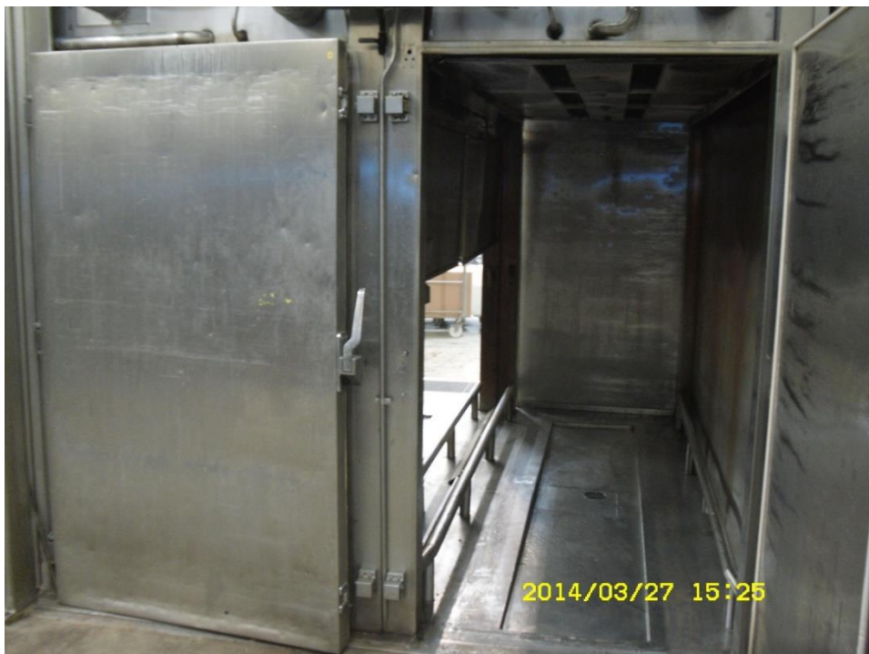
Kuva 6. Doleschal 5 -uuni sisältä. Molemmat Doleschal-uunit ovat samantyyppisiä ja niissä vaunut sijoitetaan kaksi rinnakkain ja kolme peräkkäin. (Kuva: Martti Raski)
