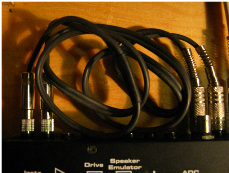
Kuvio 15. A/D-D/A –muunnoksen testauskytkentä jolla signaali reititetään äänikortin ulostuloista suoraan takaisin sisääntuloihin.
