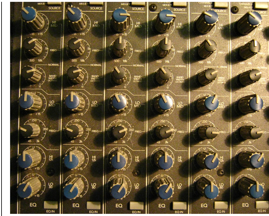
Kuvio 20. Kolmen ensimmäisen stereoryhmän EQ -asetukset analogimikserissä. Koska kanavat ovat monokanavia, täytyy stereokäytössä kahdelle kanavalle tehdä samat asetukset, poikkeuksena sähkökitara-raidat, jotka oli muutenkin ITB-panoroitu äärlaitoihin.
