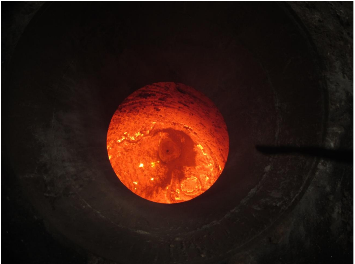
Kuva 5. Valureikäremontoidun senkan pohja
