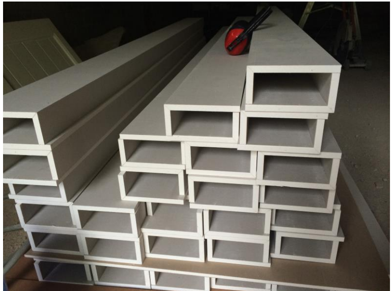
Kuva 39. Kotelot kuljetettiin työmaalle vastakkain ladottuna.
