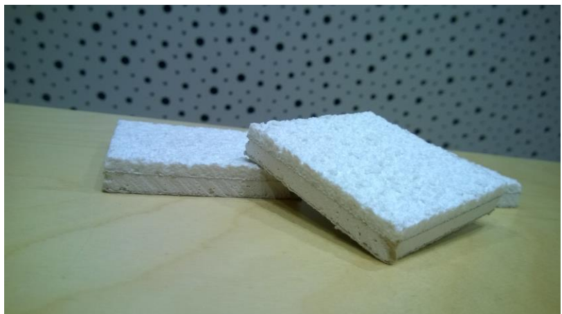
Kuva 3. Mallipalat Knauf Oy:n Lumir Board-levykaton pintakäsittelystä. [35]
