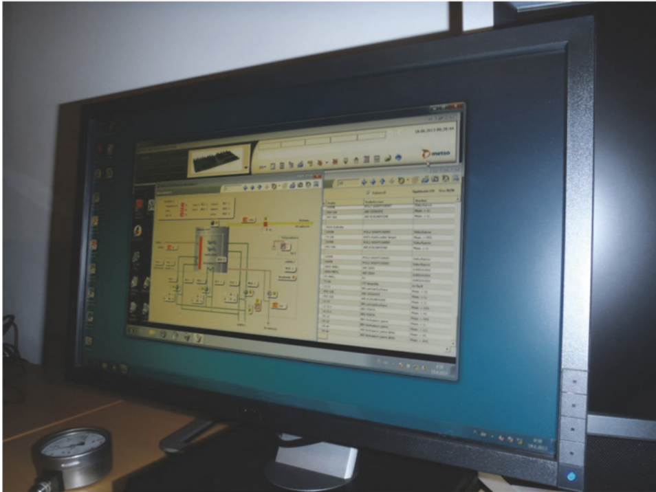
Kuva 5. Louen biokaasureaktorin Metson etäkäyttöliittymä RMM valvomossa Kemissä. Metson automaatiojärjestelmä sisältyi ammattikorkeakoulun hankintoihin.
