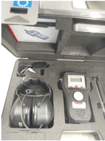
Kuva 20. a) ultraääneen perustuva vuodonpaikannuslaite
