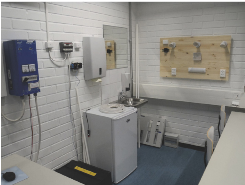
Kuva 27. Energiatekniikanlaboratorion aurinkosähkijärjestelmän oppimisympäristö, jääkaappipaketti. Vasemmassa reunassa tuulivoimalan säädin ja akku.
