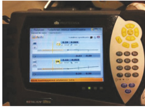
Kuva 8. Moottorin ja pumpun linjaus Rotalign Ultra mittauslaitteella. (Karlund 2014, 27, 54)
