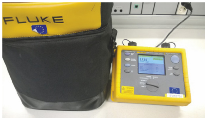
Kuva 21 Tiedonkeruulaite Fluke 1735 sähköverkon mittauksiin.
