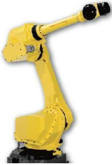
Kuva 4 Fanuc M710iC/50 -nivelsirobotti
