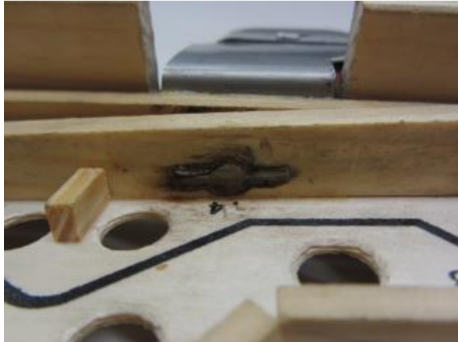
Kuva7. Akseli yhdistää sisemmän kallistuvan tason servomoottoriin. Servomoottoria ja sen tukea varten labyrintin kehiksestä on poistettu osa.
