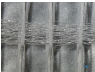
Kuva 4. Natura-teipin kuderakenne 20x suurennoksella
