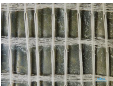
Kuva 30. TN15-CBY/W teipin kuderakenne 8x suurennoksella
