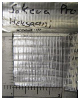
Kuva 9. Sokeva Pro -teipin kudelukku, liima on liuotettu heksaaniin
