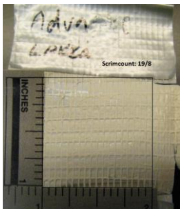
Kuva 1. Vanhemman Advance-teipin kudeluku, liima on liuotettu lakkabensiiniin
