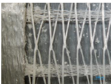
Kuva 32. Raptor-teipin kuderakenne 8x suurennoksella
