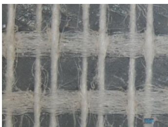
Kuva 34. Mustan Gorilla tape -teipin kuderakenne 20x suurennoksella
