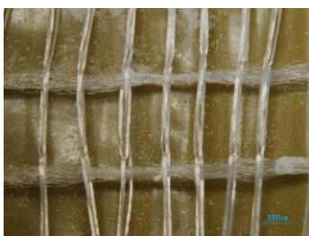
Kuva 28. Eurocel Giallo -teipin kuderakenne 8x suurennoksella
