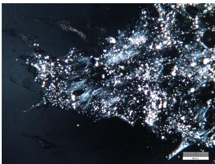
Kuva 39. Sinisen Shurtape-teipin liima polarisaatiolla 10x suurennoksella
