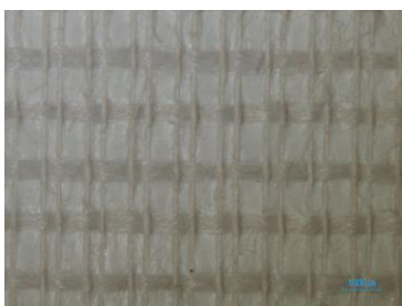
Kuva 36. Valkoisen Gorilla tape -teipin kuderakenne 8x suurennoksella
