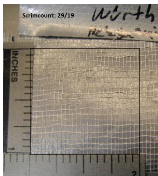
Kuva 5. Würth-teipin kudeluku, liima on liuotettu heksaaniin
