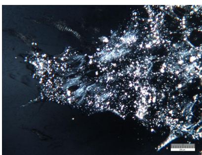
Kuva 18. Sinisen Shurtape-teipin liima polarisaatiolla 10x suurennoksella
