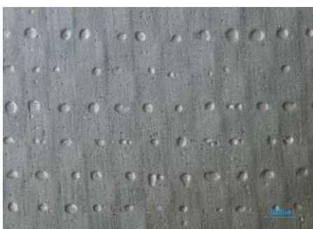
Kuva 23. Biltema-teipin kalvon pinnan painaumat 8x suurennoksella
