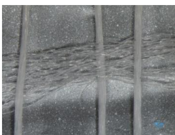
Kuva 10. Sokeva Pro -teipin kuderakenne 20x suurennoksella
