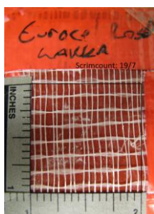
Kuva 23. Eurocel Rosso -teipin kudeluksu, liima on liuotettu lakkabensiiniin
