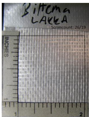
Kuva 15. Biltema-teipin kudeluksi, liima on liuotettu lakkabensiiniin
