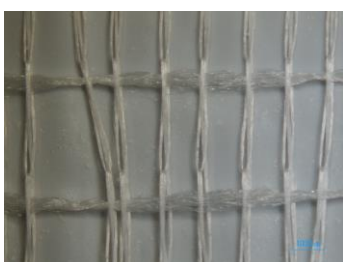
Kuva 26. Eurocel Bianco -teipin kuderakenne 8x suurennoksella
