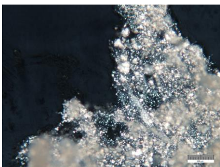
Kuva 12. Harmaan Shurtape-teipin liima polarisaatiolla 10x suurennoksella
