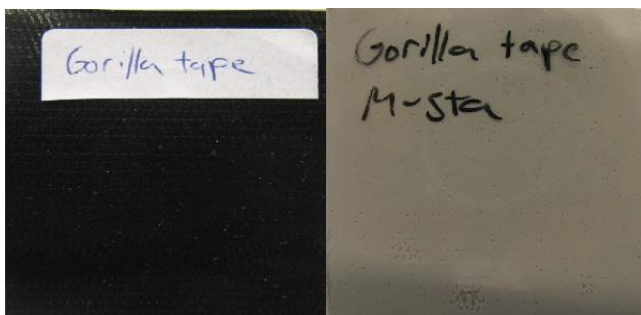
Kuva 17. Mustan Gorilla tape -teipin kalvon ja liiman värit
