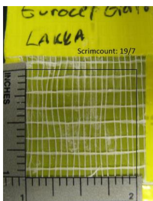
Kuva 26. Eurocel Bianco -teipin kuderakenne 8x suurennoksella
