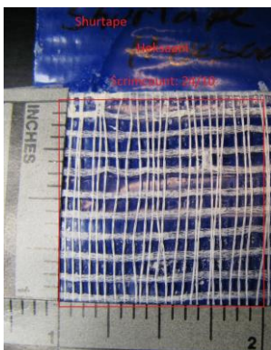
Kuva 17. Sinisen Shurtape-teipin kudeluku, liima on liuotettu heksaaniin
