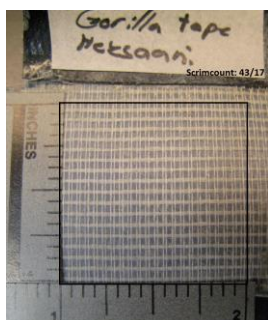
Kuva 33. Mustan Gorilla tape -teipin kudeluku, liima on liuotettu heksaaniin
