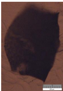
Kuva 21. Eurocel Nero -teipin kalvo fluoresenssilla 10x suurennoksella
