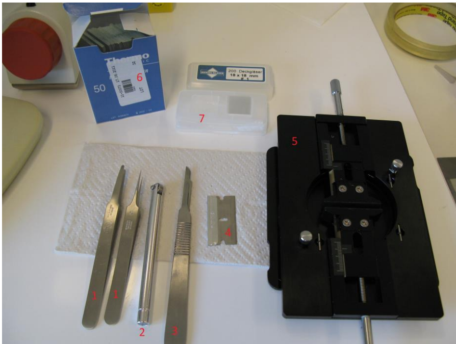
Kuva 5. Työvälineet ilmastointiteippien esikäsitelyssä: 1. pinsetit 2. metallirulla 3. veitsi 4. partaterä 5. ruuvipenkki 6. preparaattilasit 7. peitinlasit
