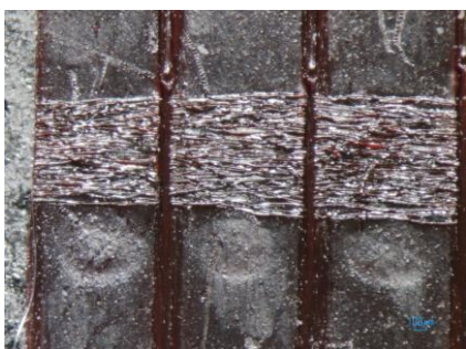
Kuva 26. Viininpunaisen Shurtape-teipin kalvon alapuolen painaumat tukilangoituksesta 20x suurennoksella
