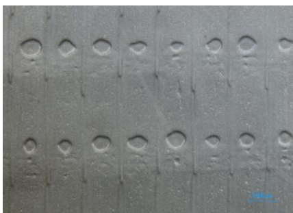
Kuva 21. Harmaan Shurtape-teipin kalvon pinnan painaumat 8x suurennoksella
