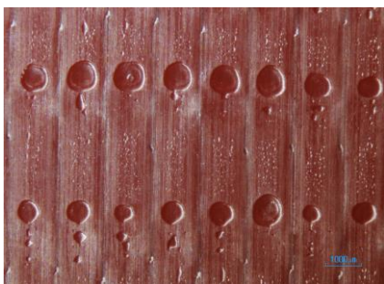
Kuva 25. Viininpunaisen Shurtape-teipin kalvon pinnan painaumat 8x suurennoksella
