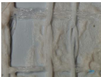
Kuva 2. Vanhemman Advance-teipin kuderakenne 20x suurennoksella
