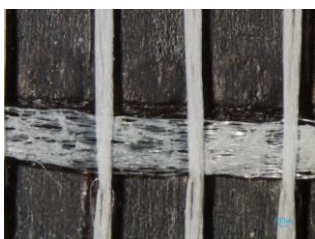
Kuva 20. Viininpunaisen Shurtape-teipin kuderakenne 20x suurennoksella
