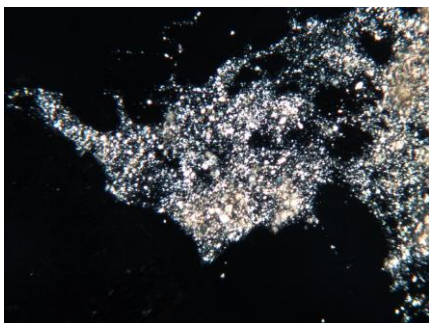
Kuva 32. Raptor-teipin liima polarisaatiolla 10x suurennoksella
