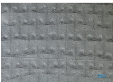
Kuva 19. Würth-teipin kalvon pinnan painaumat 8x suurennoksella
