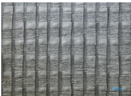
Kuva 24. Biltema-teipin kalvon alapuolen painaumat tukilangoituksesta 8x suurennoksella
