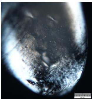
Kuva 26. Eurocel Bianco -teipin kalvo polarisaatiolla 10x suurennoksella
