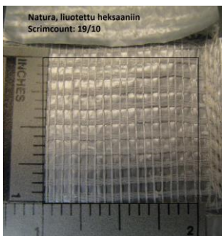
Kuva 3. Natura-teipin kudeluku, liima on liuotettu heksaaniin
