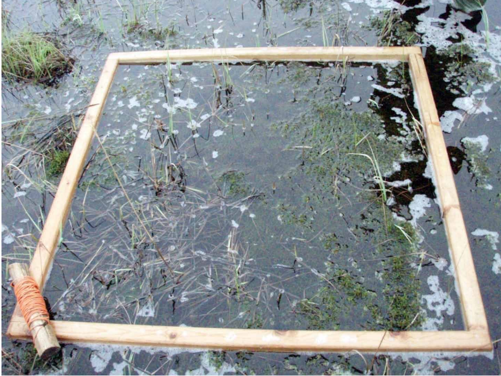
Kuva 1. Rantakasvillisuuden kartoituksessa käytettävä kasvillisuuskartoitushikko, ala 1,0 m 2 . Kuva: Jaakko Lavonen.
