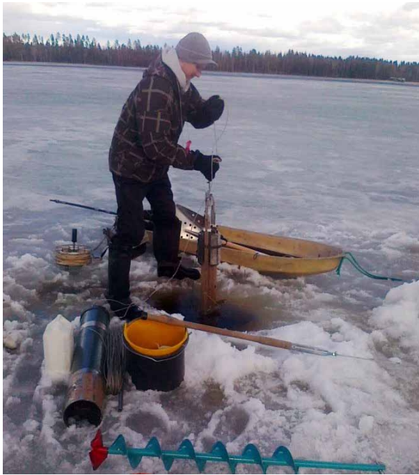
Kuva 6. Karelia-ammattikorkeakoulun opiskelija Ville Väisänen ottaa järven pohjasedimenttinäytettä viipaloivalla Limnos-noutimella.
