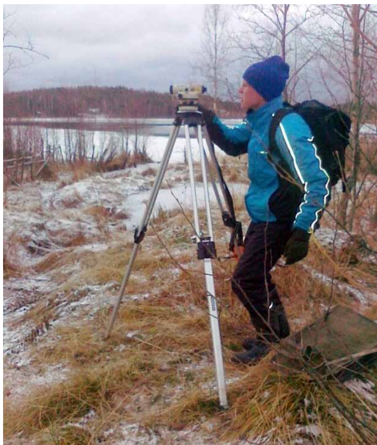
Kuva 14. Karelia-ammattikorkeakoulun insinööriopiskelija Juha Hyvärinen selvittää vesiensuojeluteknisten rakenteen mahdollista sijaintia vaaituslaitteen avulla Vuonisjärven ranta-alueella marraskuussa 2012.
