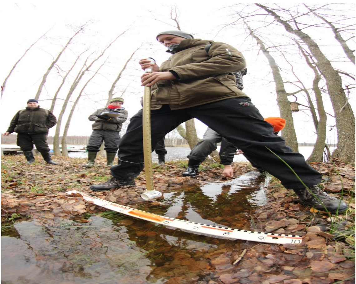
Kuva 8. Virtaaman mittaamista 24.3.2014 Global Water© -siivikolla. Taustalla lämpötilan mittaus. (Kuva: Atte Varis).
