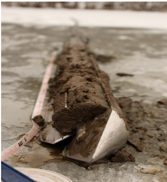
Kuva 17. Esimerkki yleisimmin esiintyvistä ruskeasta hienojakoisesti pohjasedimentistä. (Kuva: Atte Varis).
