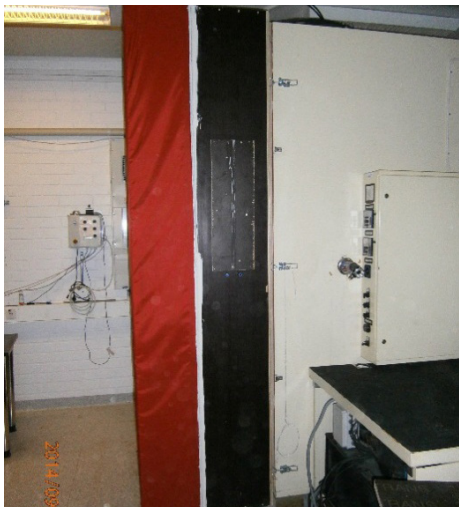
Kuva 17. Testilaitteisto ilmanpitävyysmittauskuvulla varustettuna
