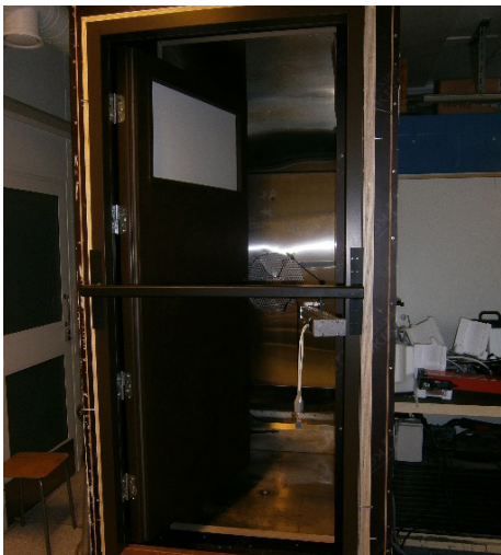
Kuva 16. Kuvissa näkyy tuote / ovi asennettuna testilaitteistoon
