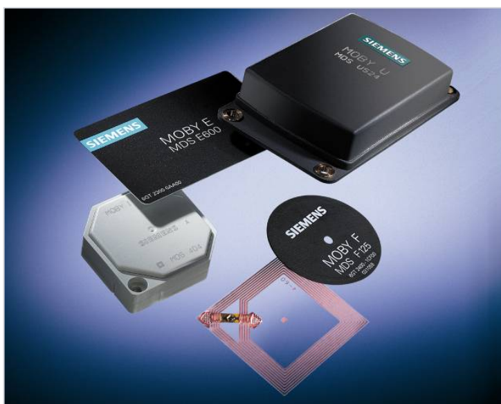
Kuvio 6. Aktiiviset ja passiiviset RFID- tunnistet.
