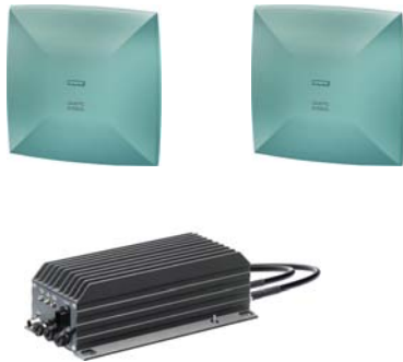
Kuvio 7. Aktiivisen RFID- järjestelmän lukija ja ulkoinen antenni.
