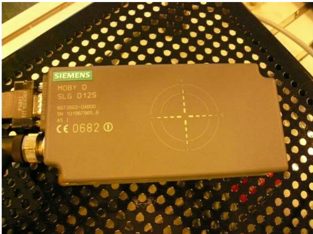
Kuvio 10. Siemens Moby D SLG D12S RFID -lukija
