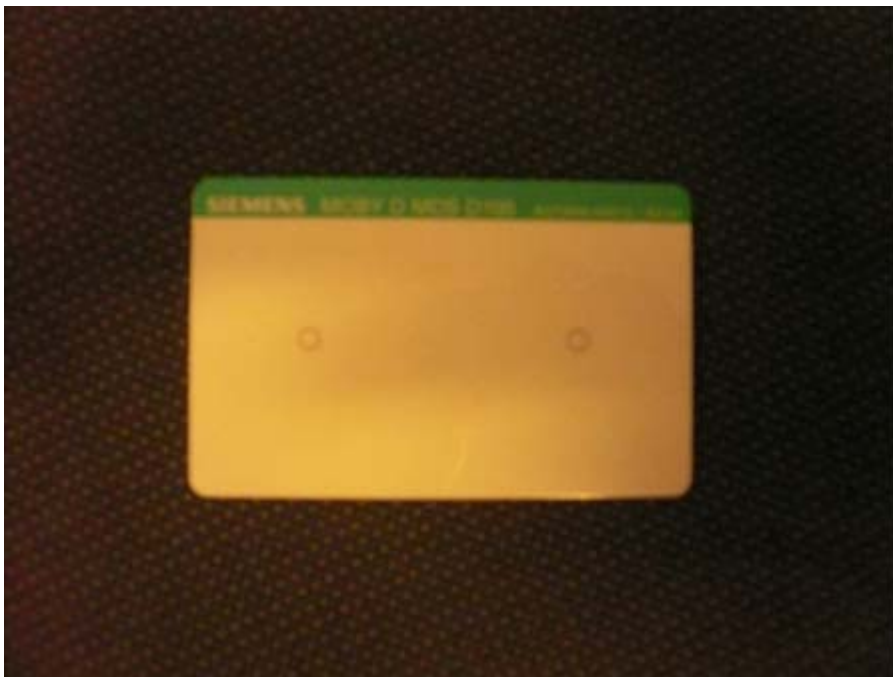
Kuvio 9. Siemens Moby D MDS D100 passiivinen RFID-tunniste
