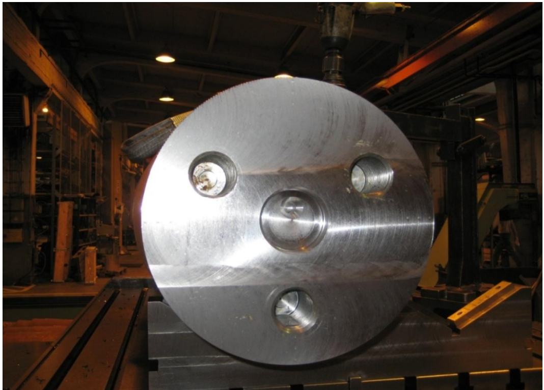
Kuva 5 Epäkeskoakselin pään koneistus valmiina
