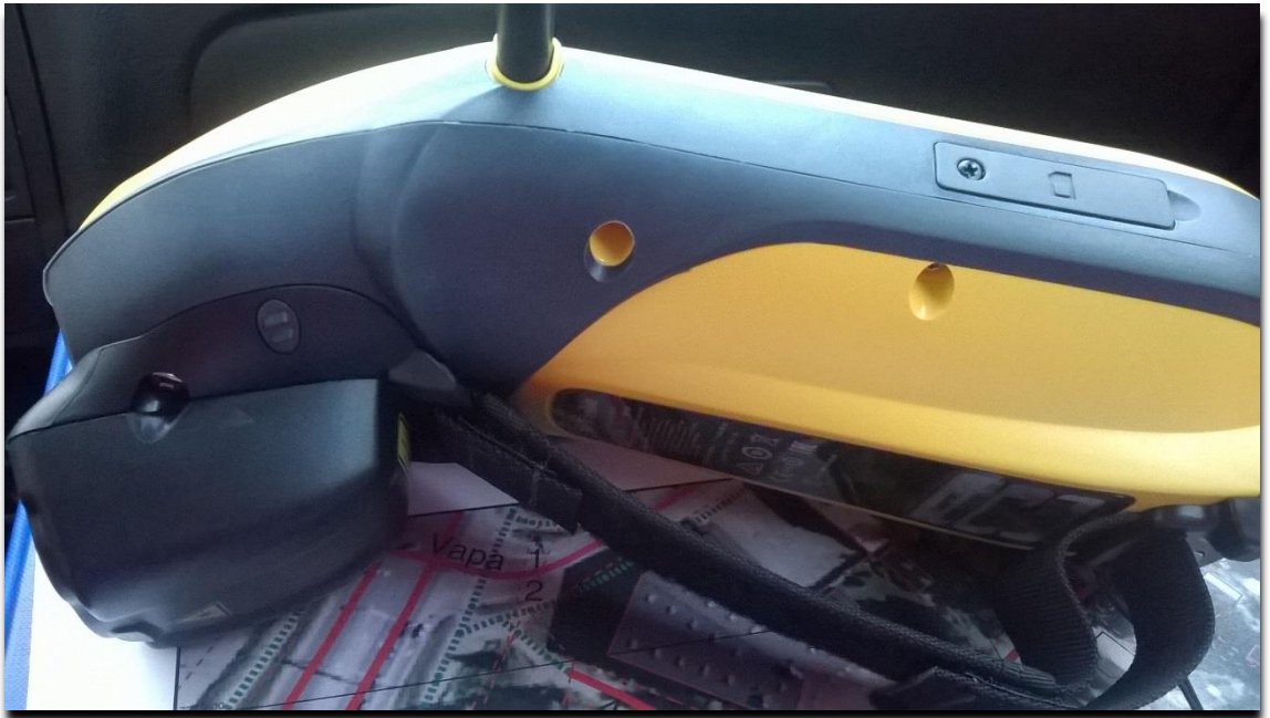
KUVIO 20. Geo7 ja laser kiinnitettyä alapuolella.
