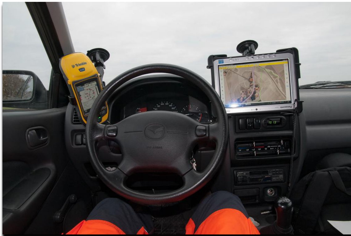
KUVIO 18. Tabletti ja Geo7 asennettuna autopidikkeisiinsä. (Ruostetoja 2014)
