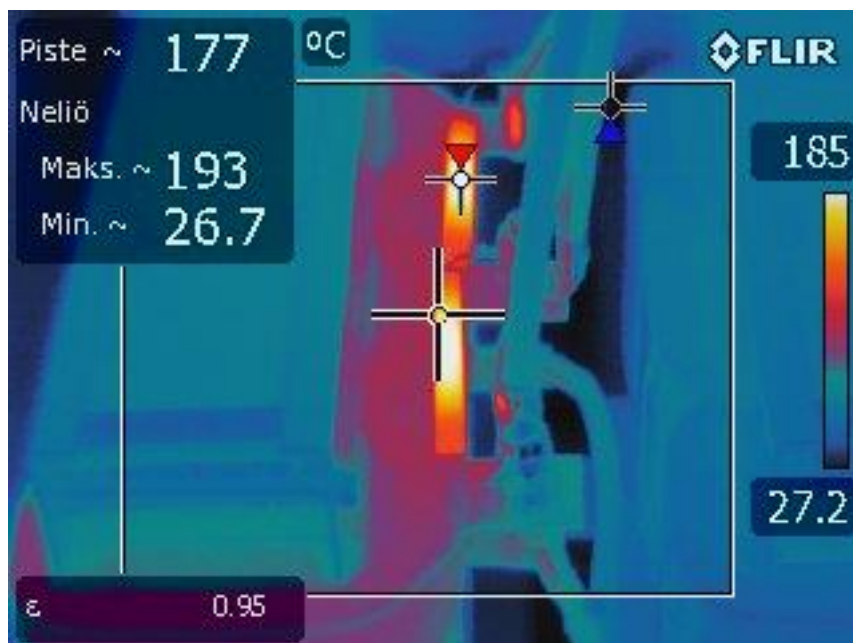
Kuva 12. Korkea lämpö saattaa vaurioittaa purkausvastuksia, minkä seurauksena paristo ei purkaudu.
