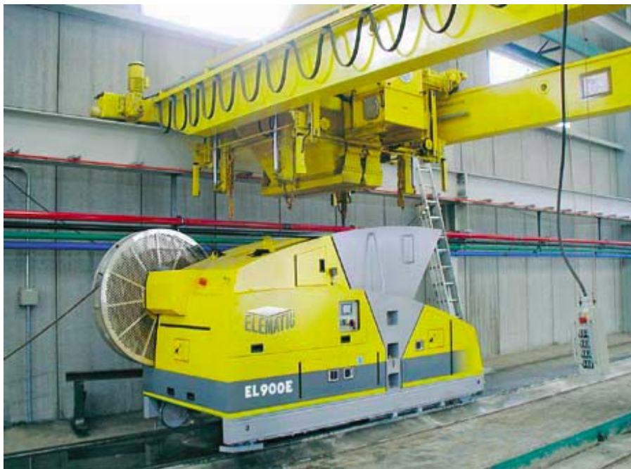
Kuvio 7: Extruder-valukone valupetillä. Yllä välikuljetin, joka annostelee betonimassan valukoneeseen./7/
