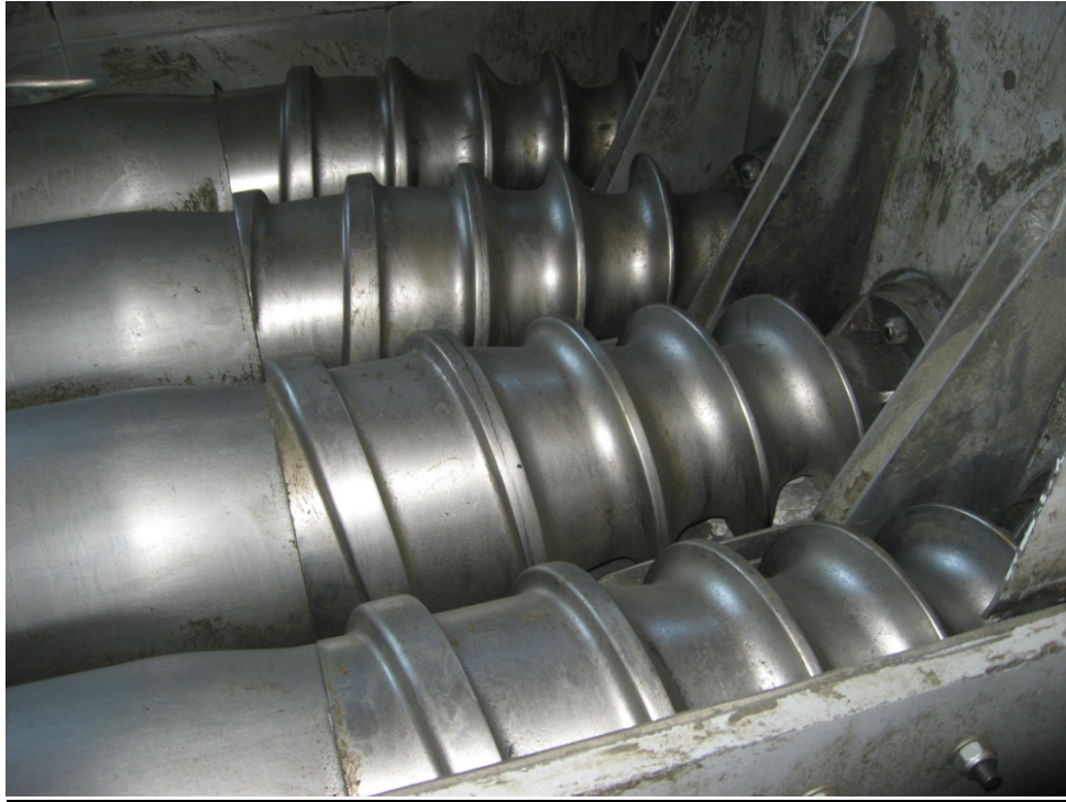
Kuvio 9: Valukoneen uudenveroiset syöttöruuvit ja niiden perässä vasemmalla ontelotuurnat, jotka muodostavat laatan ontelot.
