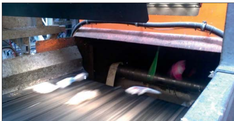
KUVA 6. Optinen NIR-tekniikkaan (Near Infrared) perustuva erottelu Sita Waalhavenin lajittelulaitoksella (kuva Panu Jouhkimo)
