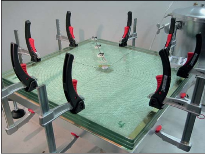
KUVA 4. RTM muotti valmiina koetta varten (kuva Markus Bruun)
