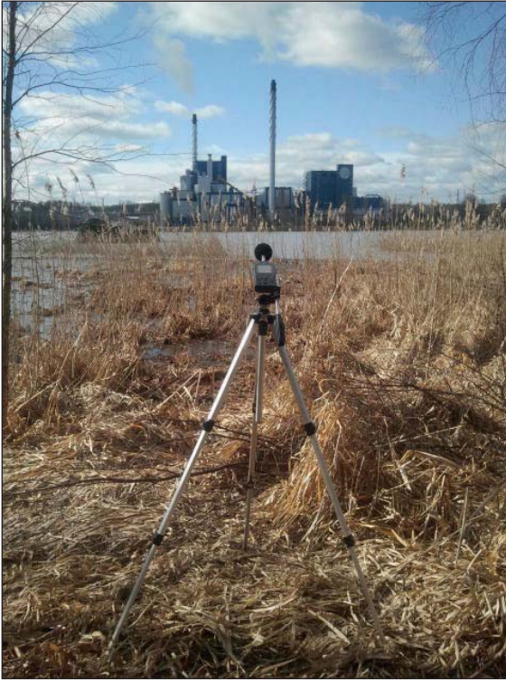
KUVA 4. Melunmittauslaitteisto sijoitettuna Rauhaniemen asuinalueelle (kuva Petra Kivistö)
