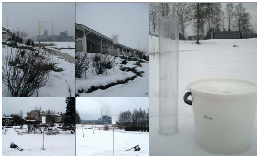
KUVA 2. Rauhaniemen ja Kenkäveronniemen laskeumankeräimet kahdesta eri kuvakulmasta (vasemmalla) sekä luminäytteenottovälineistö (oikealla) (kuvat Petra Kivistö)
