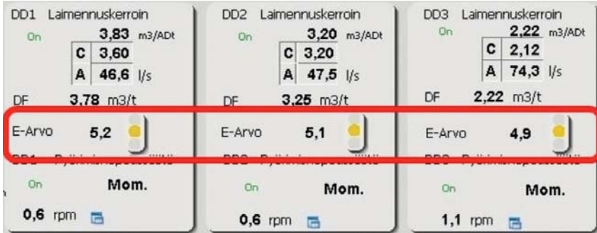
KUVA 5. E-arvot ja ”liikennevalot” ylemmän tason säädön operointi näytöllä (Kopra et al. 2014)
