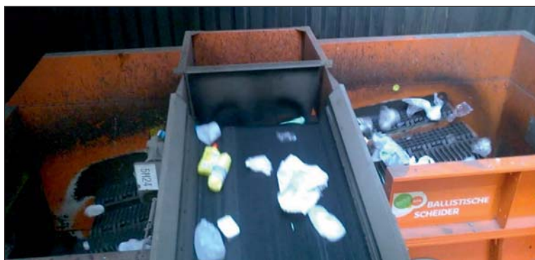
KUVA 5. Ballistinen erottelu Sita Waalhavenin lajittelulaitoksella (kuva Panu Jouhkimo)
