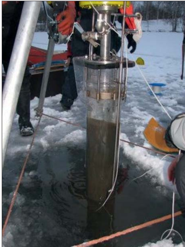
KUVA 3. Sedimenttinäytteenottoa putkinoutimella (kuva Arto Sormunen). Vastaavan näytteenottimen toimintaa tutustutaan vesistö- ja vesistönäytteenoton erikoistutkimuskursseilla.
