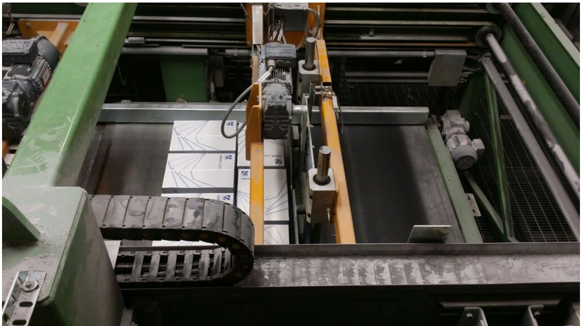
Kuva 8. Laatikkokerros muodostuu yksi rivi kerrallaan
