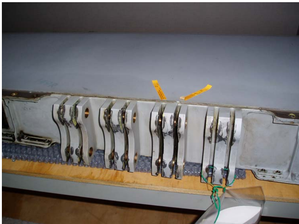
Kuva 10 Etureunasiivekkeen sarana-alue. Säröytyminen alkaa suurimmalla todennäköisyydellä korvakkeiden juuresta /1/
