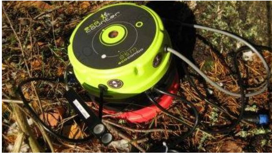
Kuva 3. Eco-combo liikennelaskuri (Finn-Raj Oy, a).
