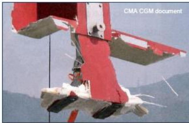
Kuva 7. Pelastusveneeseen pettänyt rakenne. (Cma Cgm Christophe Colomb Report Of Safety Investigation Lifeboat Accident During A Drill. 2011. Sivu 40)
