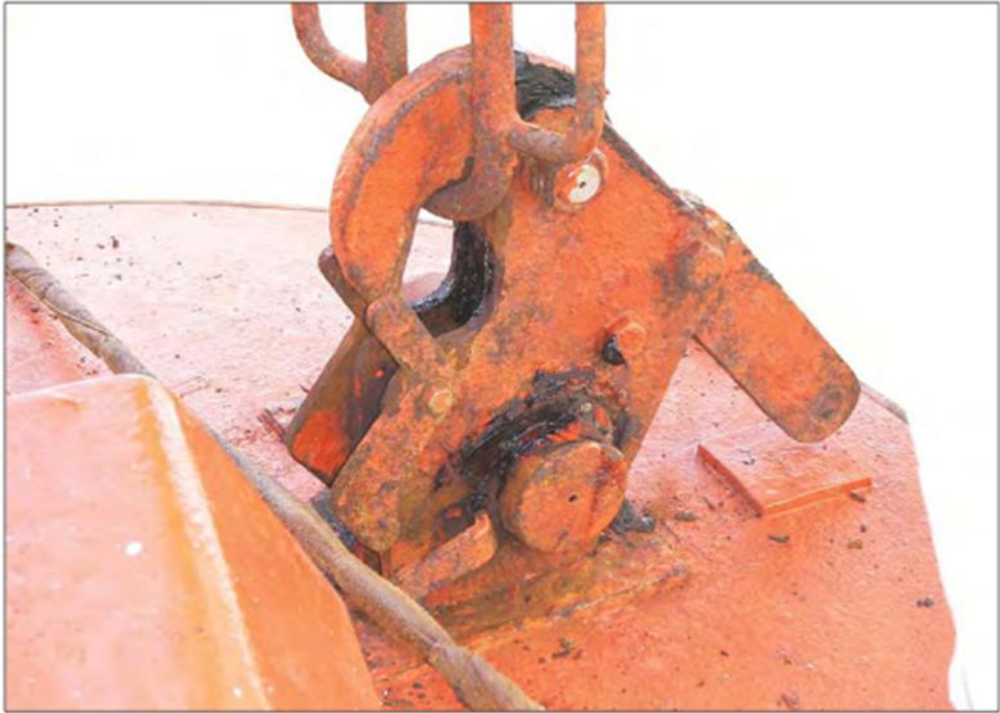
Kuva 6. Koukkumekanismi. (Lowland's Grace Investigation Report. 2006)
