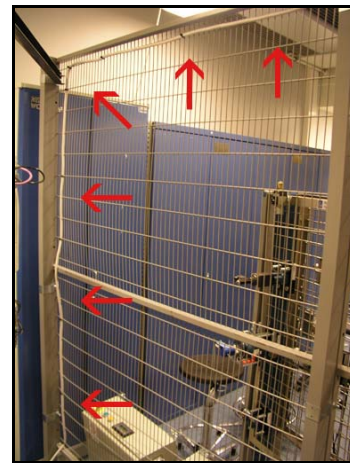
Kuva 2.11 Nomak-kaapeli turvarajalle ja oven lukolle häkin seinään kiinnitettynä
