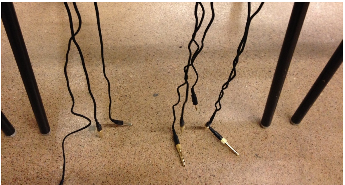
Kuva 10. Ehjien kuulokkeiden suorat ja rikkinäisten kiharaiset johdot.
