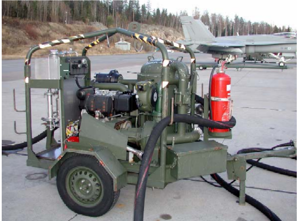
KUVA 21 Hazt-diesel lisäaineenannostelulaitteistolla varustettu pumppukärri/1/
