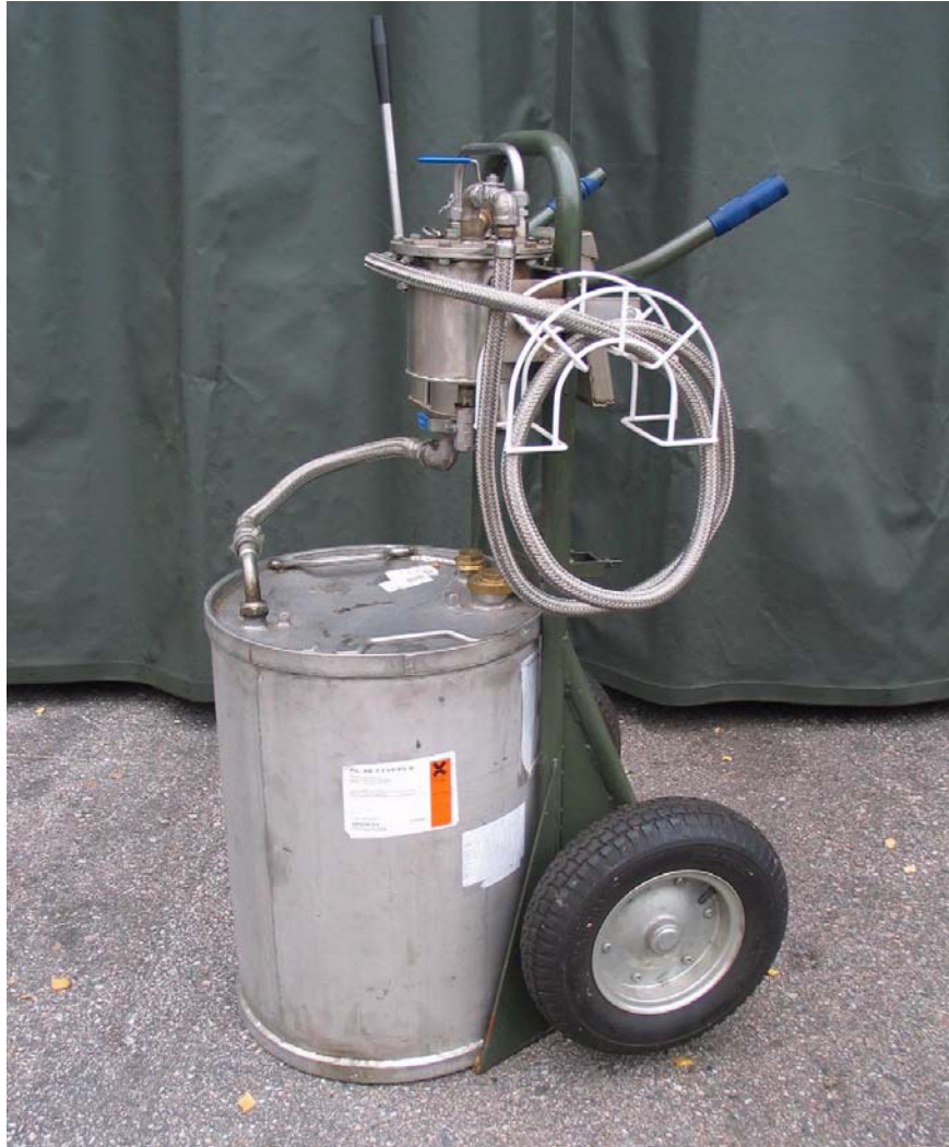
KUVA 28 100 litran lisäainetyynyillä varustettu annostelulaitteiston täyttölaite/1/
