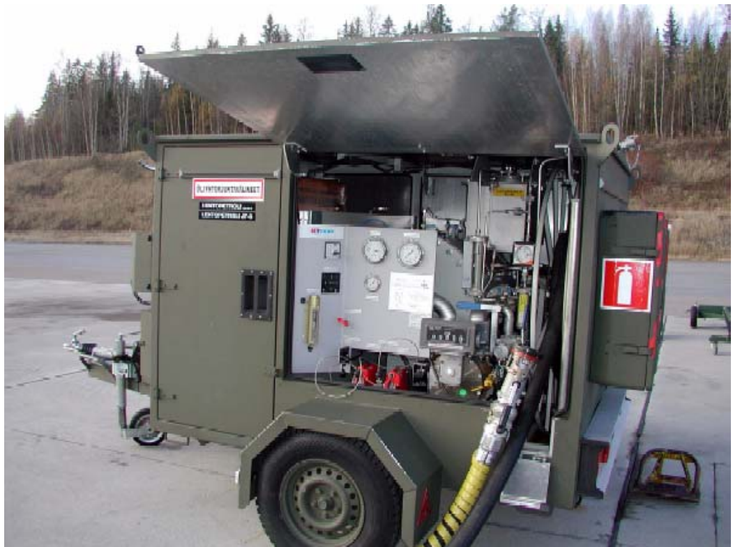
KUVA 22 M2000 lisäaineenannostelulaitteistolla varustettu pumppukärri/1/
