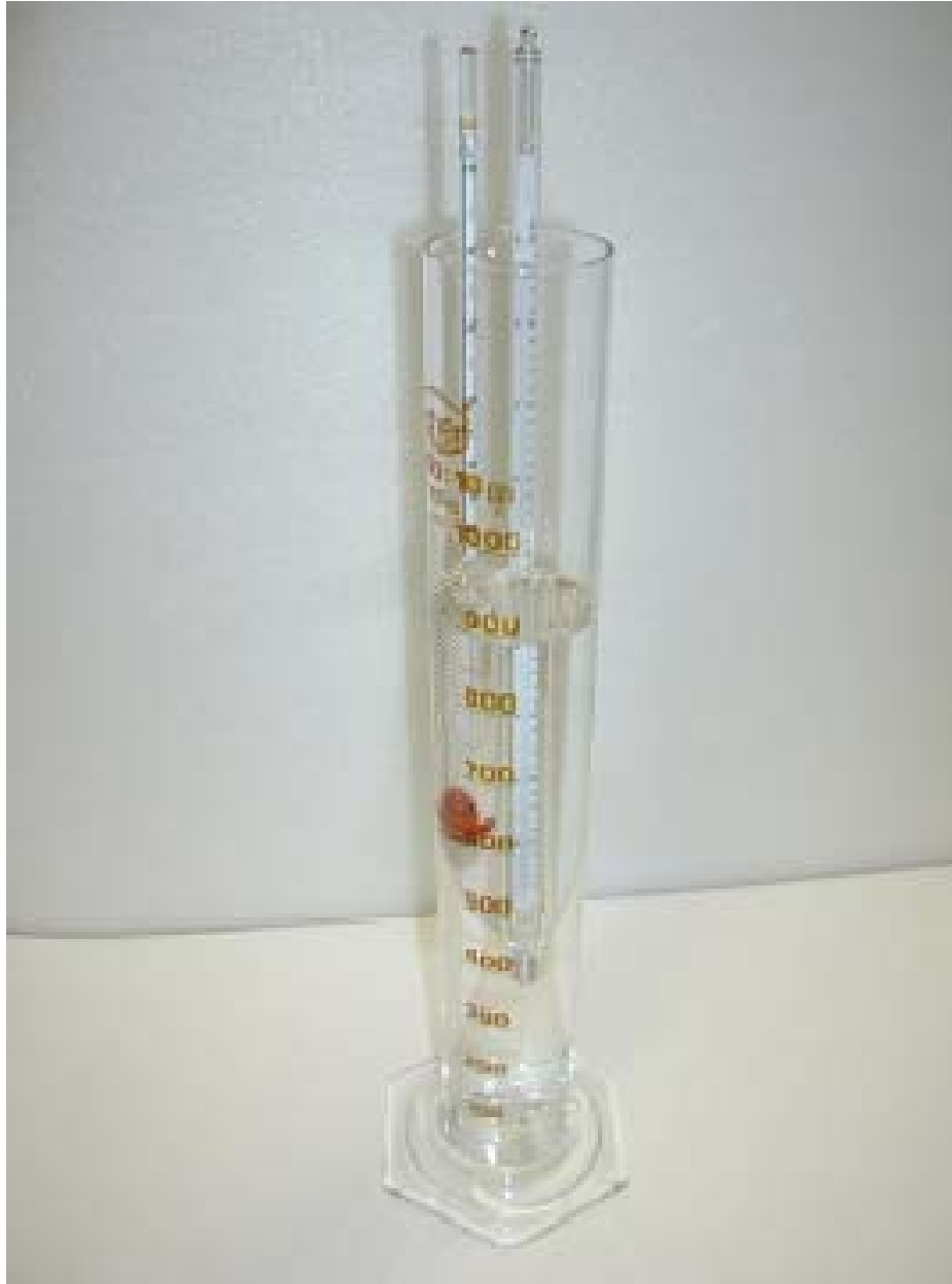
KUVA 6 Ominaispainon mittauksessa tarvitaan mittalasi, lämpömittari ja areometri/1/
