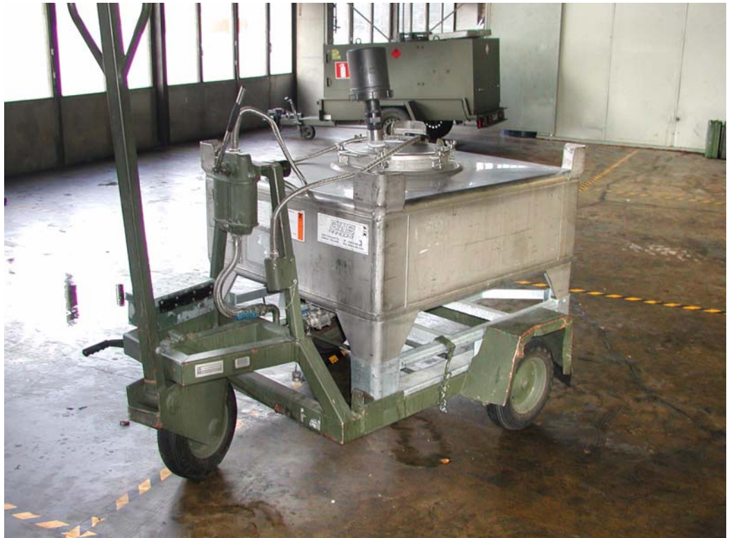
KUVA 27 500 litran lisäainekontilla varustettu annostelulaitteiston täyttölaite/1/
