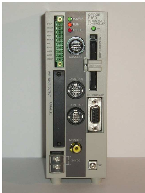
Kuva 7 Omron F160 Controllerin (ohjauslaite) etupaneeli.
