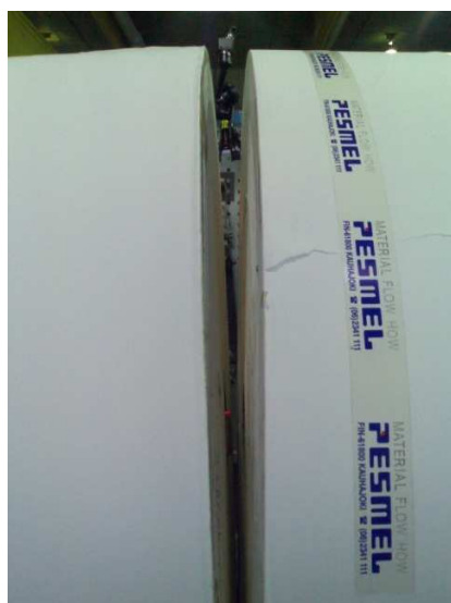
Kuva 1 Paperirullien väliin muodostunut 2,5 asteen rako.
