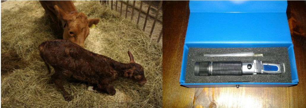
Kuva 1. Vastasyntynyt vasikka tarvitsee hyvälaatuista ternimaitoa mahdollisimman pian syntymänsä jälkeen. Kuva 2. Ternimaidon laatu voidaan tilalla mitata helposti ja nopeasti refraktometrillä (Brix 0-32 %), esimerkiksi kuvan refraktometrillä (EURO-MEX RF.5532, Hollanti). (Kuvat: Ann-Helena Hokkanen ja Marja Viitala)
