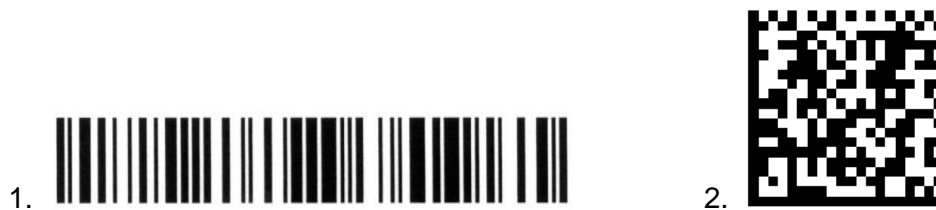
Kuva 6. Esimerkki tavat esittää UDI-koodi koneellisesti luettavana. 1. Lineaarinen 128-merkkinen viivakoodi. 2. Kaksiulotteinen Data Matrix-koodi.
