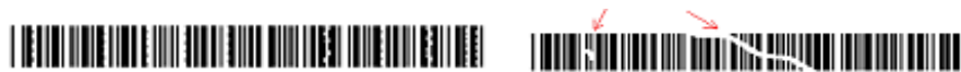
Kuva 34. Vasemmanpuoleisessa viivakoodissa esiintyy pientä rosoisuutta, mutta tämä on edelleen hyväksyttävän laatuista. Oikeanpuoleisessa viivakoodissa on katkoksia ja naarmu, minkä takia tämä ei täytä yleisiä laatuvaatimuksia. [14, s. 3.]
