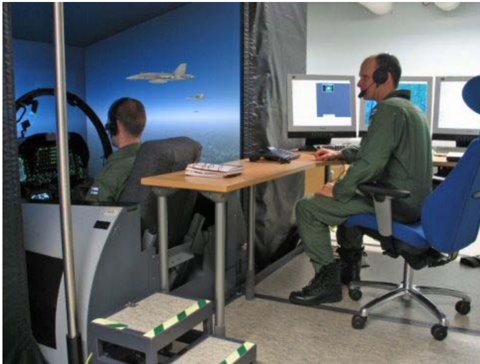
Kuva 4 Suomen ilmavoimien F/A-18 Taktinen lentosimulaattori /20/
