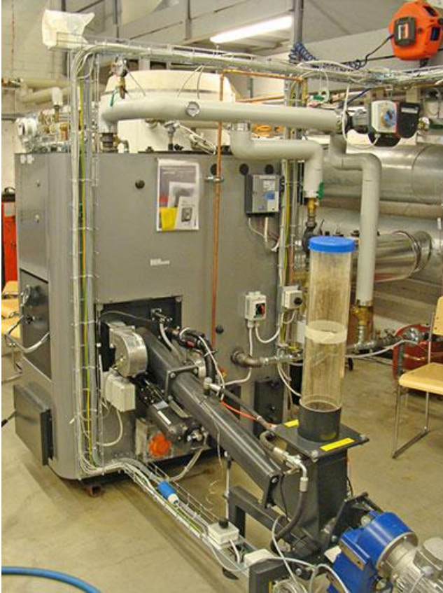
KUVA 2. Kiinteää polttoainetta, esimerkiksi haketta, voidaan polttaa kattilassa (kuvaajat: Jouni Kääriäinen ja Erkki Kylmänen)
