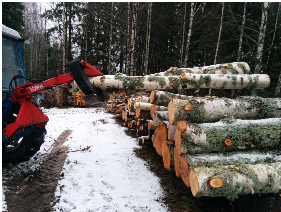
Kuva 1. Juontokouralla puut voidaan nostaa halutunlaiseen pinnoon.
