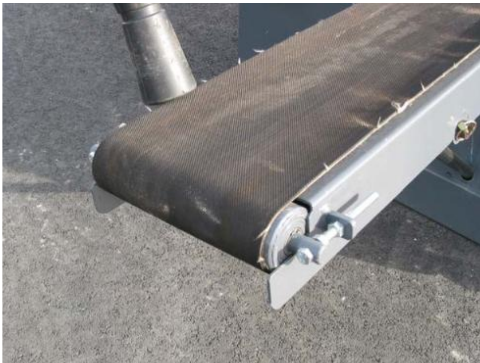
Kuva 2. Palax klapikoneen hihnakuuljetin, joka on rullien tukema. (kuva: palax.fi)
