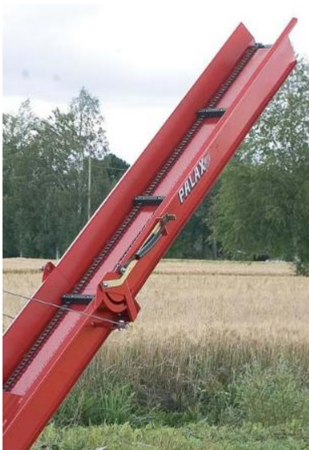
Kuva 3. Palax klapikoneen poistokuljetin, joka on toteutettu ketjukuljettimella. (kuva: palax.fi)
