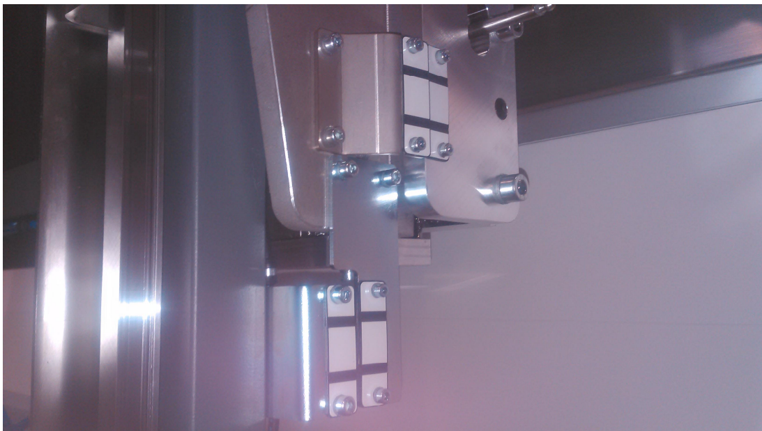
Kuva 7. MBR 800+ sarjan robotin Z-liike referenssimerkeillään.
