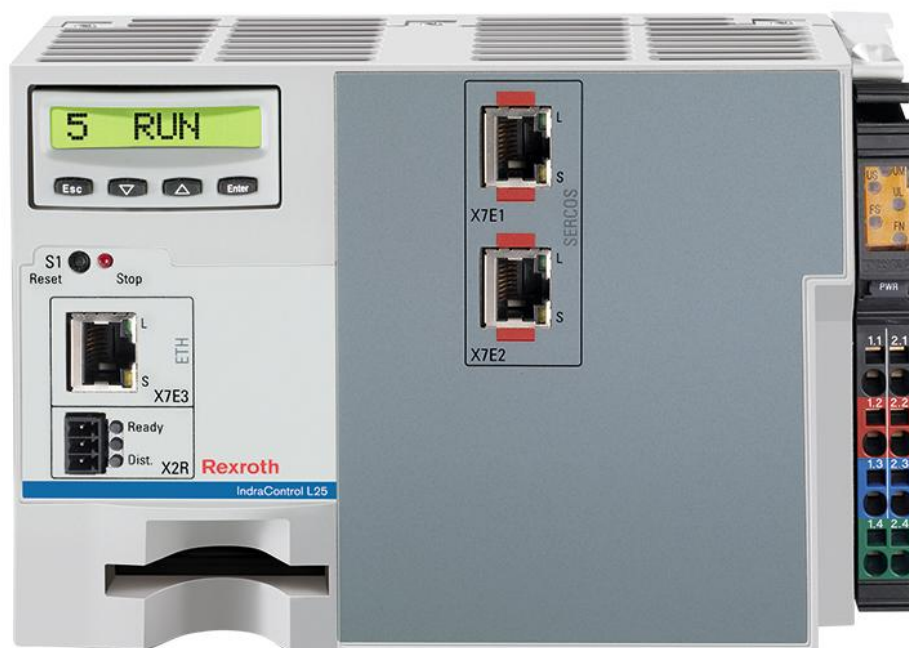
Kuva 11. Bosch Rexrothin päivitetty logiikkaversio L25, kuvassa oikeanpuoleiset RJ45-liittimet ovat MultiEthernet-liittimiä. ( www.boschrexroth.com )
