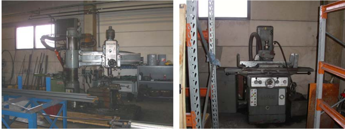
Kuva 9 Säteisporakone ja puristin työkalujen hiontaan käytettävä tasohiomakone
