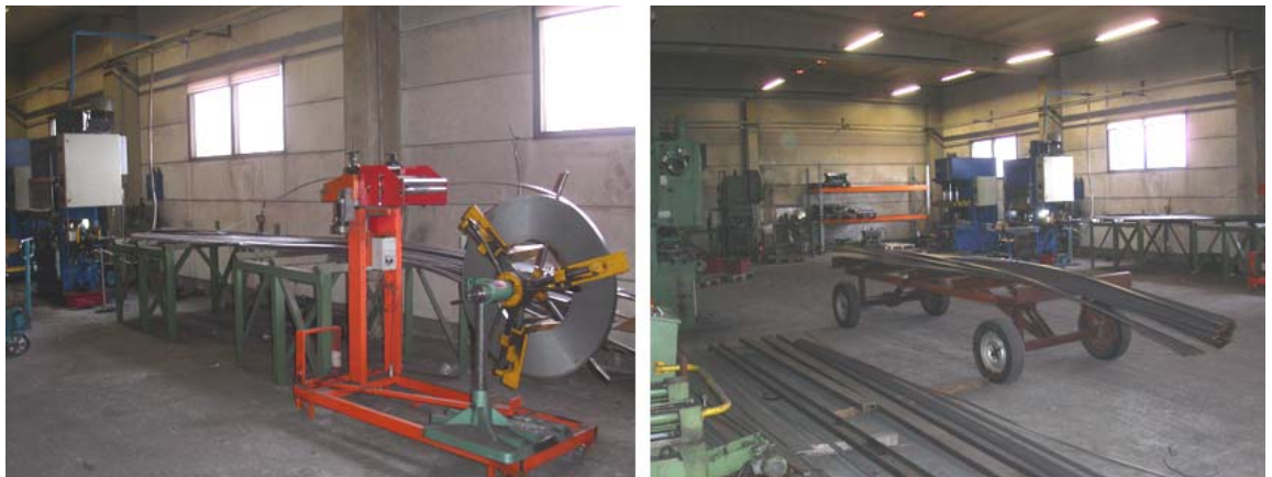
Kuva 8 Kelanpidin ja pukit lattaraudoille sekä rautojen siirtoon käytettävät lattakärkyt
