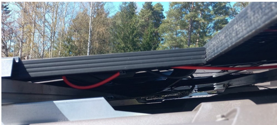
Kuva10. Pientä roikkumista, mutta suurimmaksi osaksi johdot kiinni paneeleissa.
