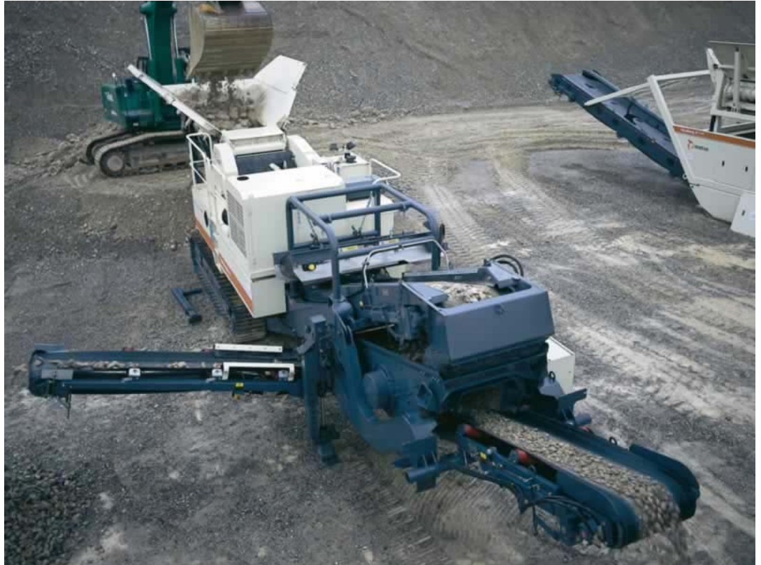
Kuva 9 Lokotrack LT95S, seulamoduuli etualalla /13/
