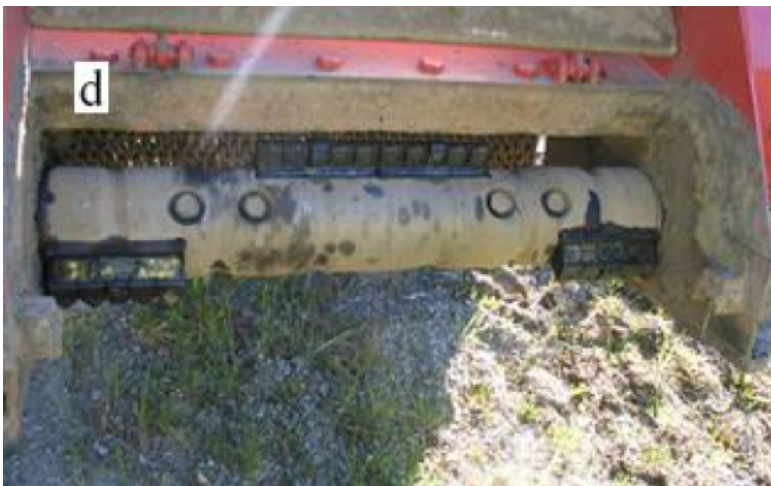
Kuva 4. Bugnot-työkoneen rumpu ja kovapalaterät (Huuskonen-2009-03-18)
