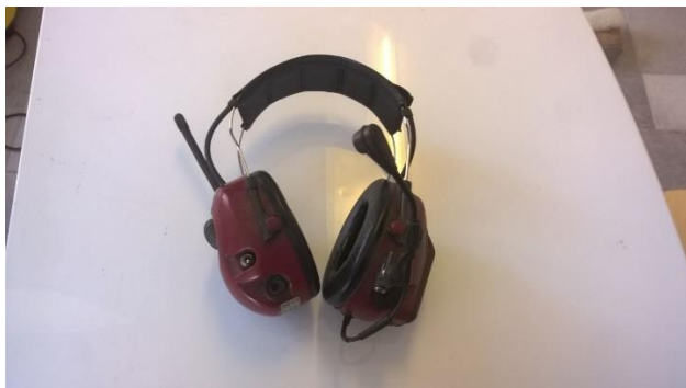
Kuva 3. Kuppikuulosuojaimet aktiivi ominaisuudella ja radiovastaan ottimella.
