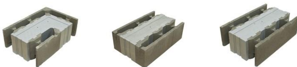
Kuva 17. Oikealta vasemmalle, nurkkaharkko, päätyharkko ja suoraharkko. (Rudus)
