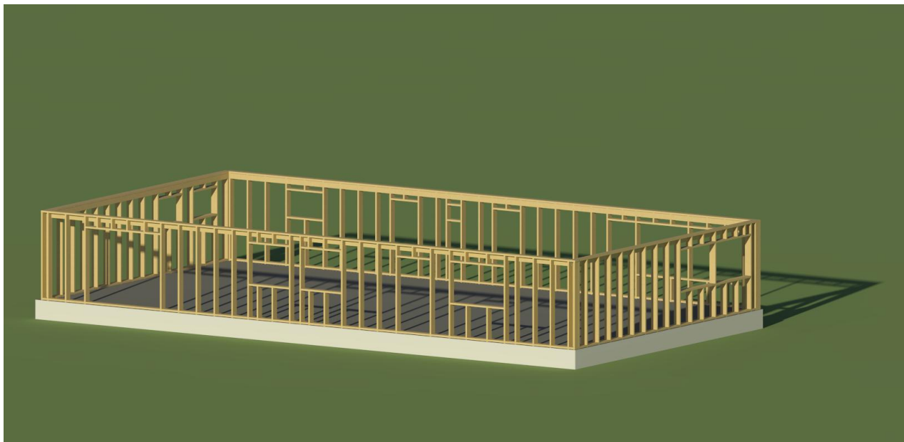
Kuva 21. Kuvassa valmis puurunko.
