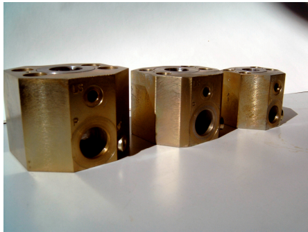
Kuva 1. PV-SAE \frac{3}{4} "-1 \frac{1}{4} " venttiilit
