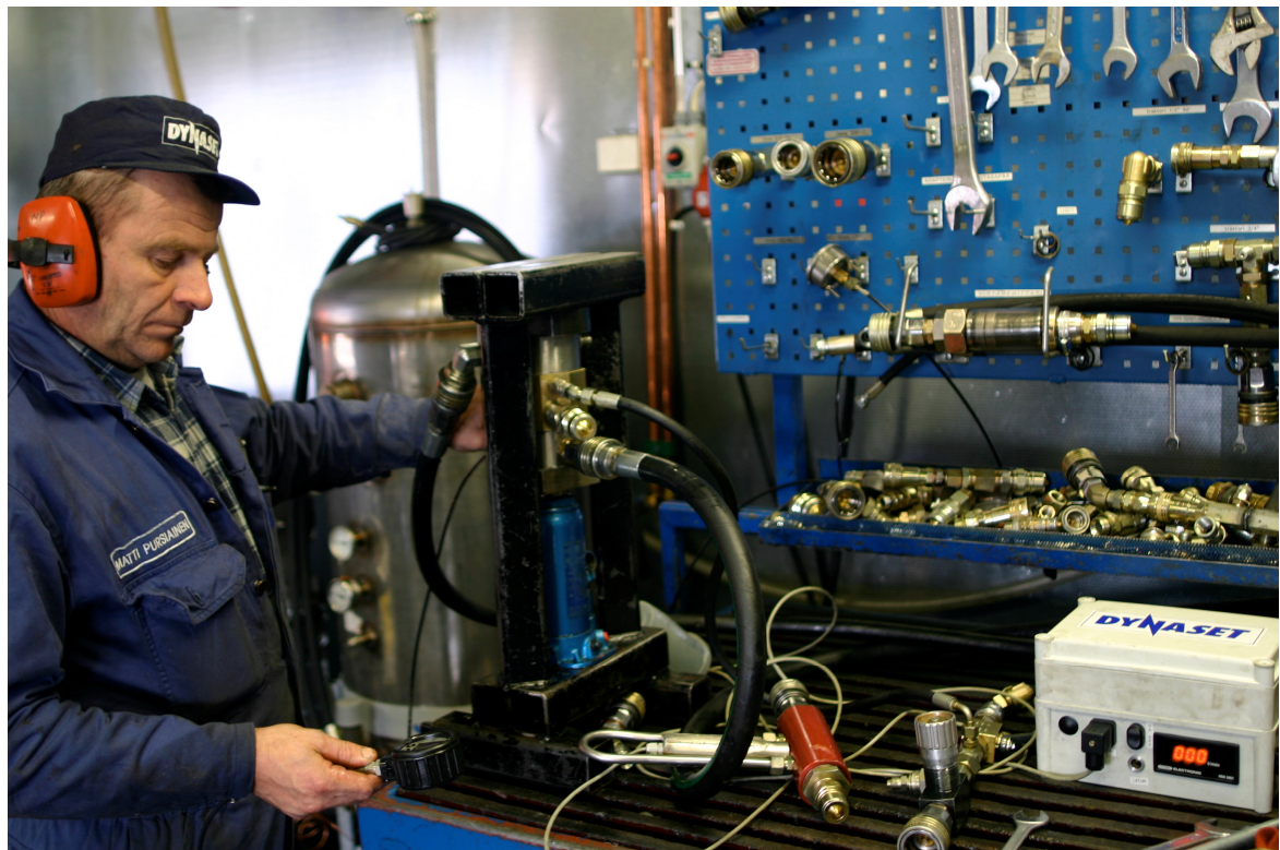
Kuva 2. Valokuva PV-SAE venttiilin koeajosta. Kuvasta voi nähdä venttiilin puristettuna pullotunkin avulla ja venttiiliin kytketyt pikaliittimet.
